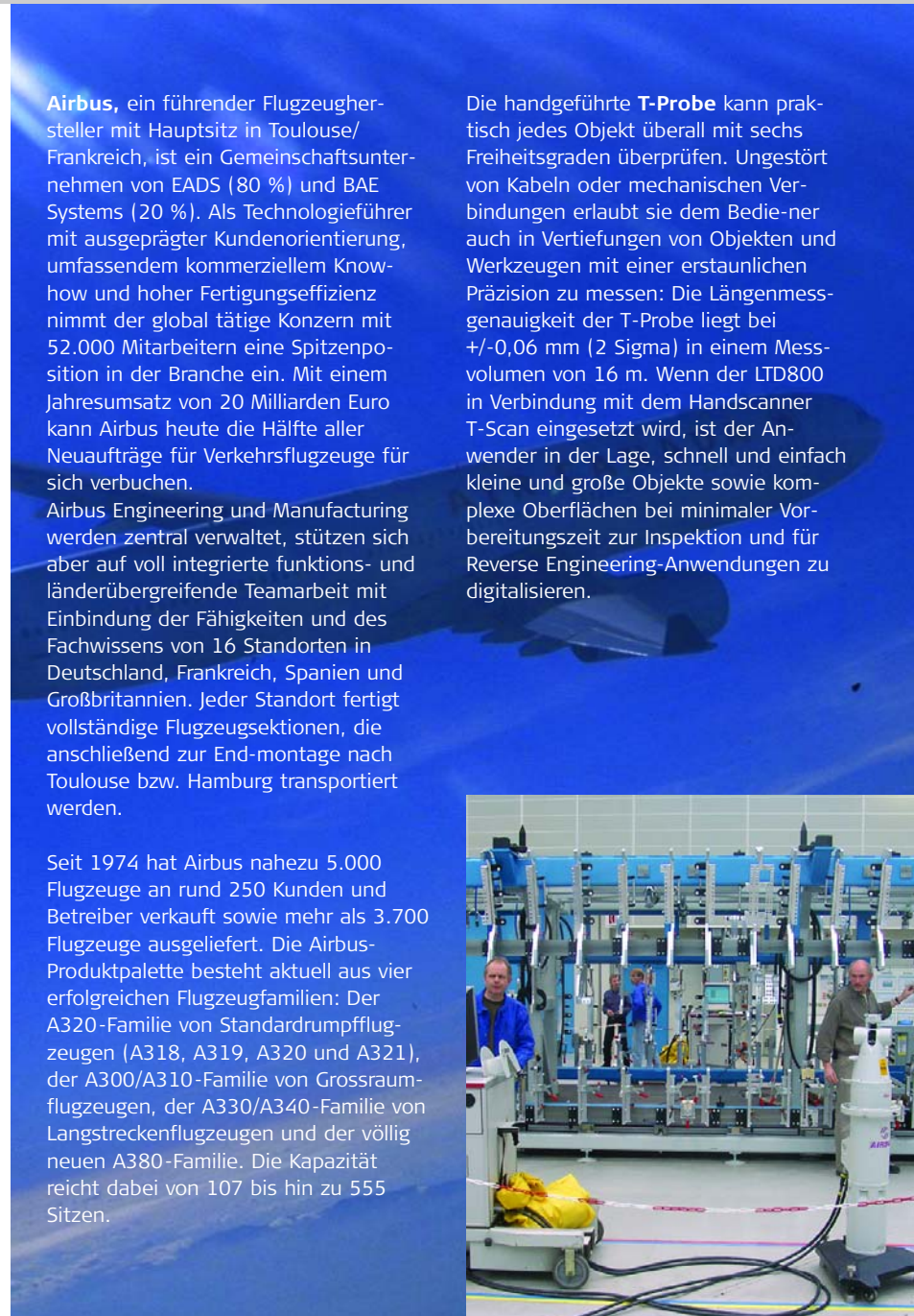
Messungen an der Vorrichtung für die innere Landeklappe der A320-Familie, die zukünftig in Bremen produziert wird. Die Vorrichtungen werden mit dem Leica Tracker nicht nur aufgebaut, sondern auch abgenommen.
