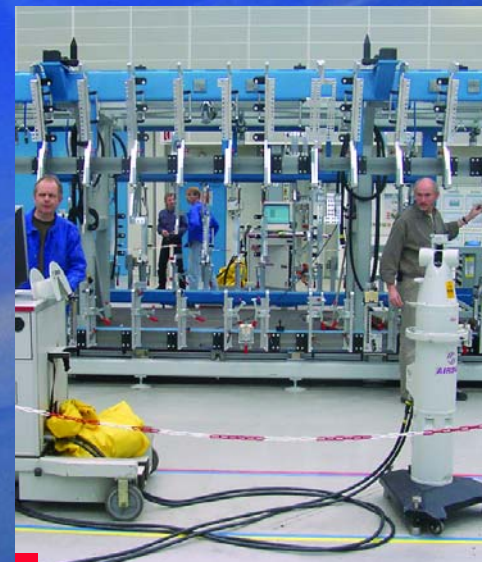
Messungen an der Vorrichtung für die innere Landeklappe der A320-Familie, die zukünftig in Bremen produziert wird. Die Vorrichtungen werden mit dem Leica Tracker nicht nur aufgebaut, sondern auch abgenommen.
