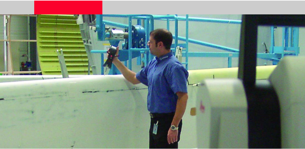
Mit der Kombination aus Laser Tracker und T-Probe werden Grossbauteile wie hier die äussere Landeklappe des A318 vermessen.
