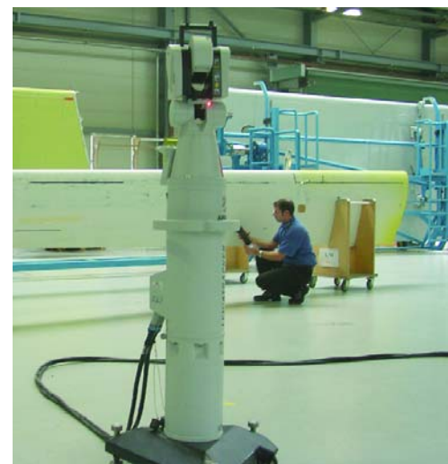
Die handgeführte T-Probe erlaubt den Messtechnikern, Messungen noch schneller und kostengünstiger durchzuführen.
