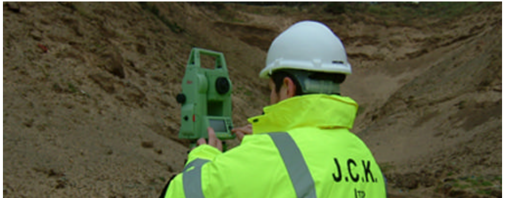
Eine der wichtigsten Einsatzmöglichkeiten der TCR 407power ist die Ermittlung von Abbaumengen und Deponievolumen.
